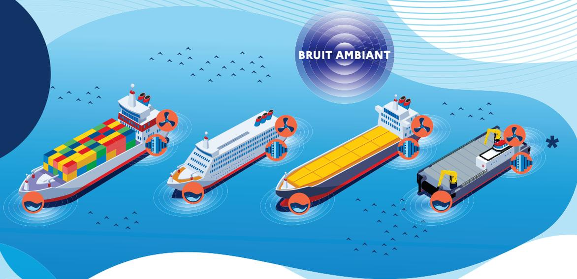
\* Il existe une grande diversité de navires, chacun ayant sa propre signature acoustique. L'intensité sonore d'un navire dépend de plusieurs paramètres tel que le type et la taille du navire, son âge, sa motorisation, sa coque, sa vitesse.
