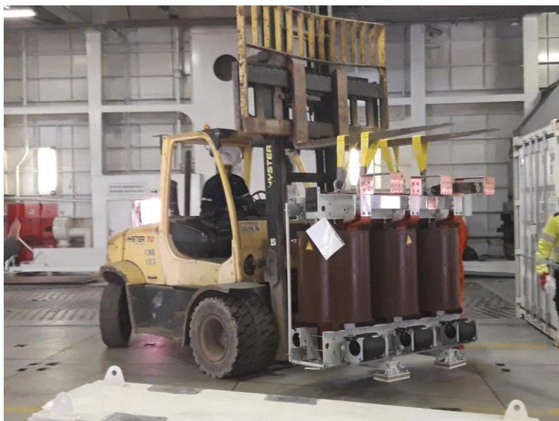
*Vue sur le transformateur installé à bord du Paglia Orba pour permettre de transformer la tension GPMM de 11500V en 410V, valeur de la tension à vide du bord.*
