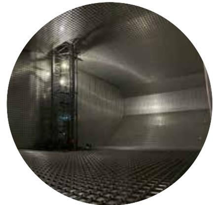
Stocké à l'état liquide dans la cuve, le gaz naturel passe à l'état gazeux pour alimenter les moteurs du navire. Ce processus de gazéification et de mise en pression du gaz est un processus complexe. Il faut l'ajuster aux consommations des moteurs qui dépendent de l'allure du navire et de la consommation électrique à bord. La mise au point de cette régulation est un des points clés de ce navire.
