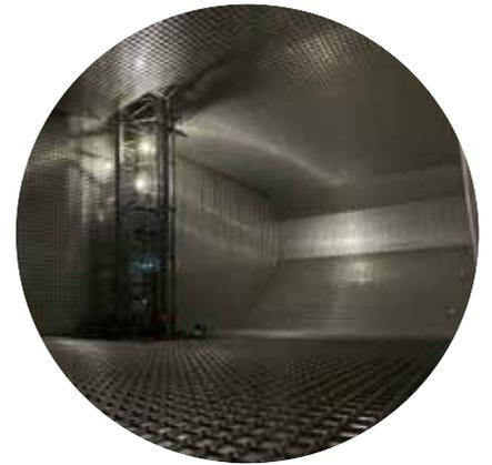
Stocké à l'état liquide dans la cuve, le gaz naturel passe à l'état gazeux pour alimenter les moteurs du navire. Ce processus de gazéification et de mise en pression du gaz est un processus complexe car il faut l'ajuster aux consommations des moteurs qui dépendent de l'allure du navire et de la consommation électrique à bord. La mise au point de cette régulation est un des points clefs de ce navire.
